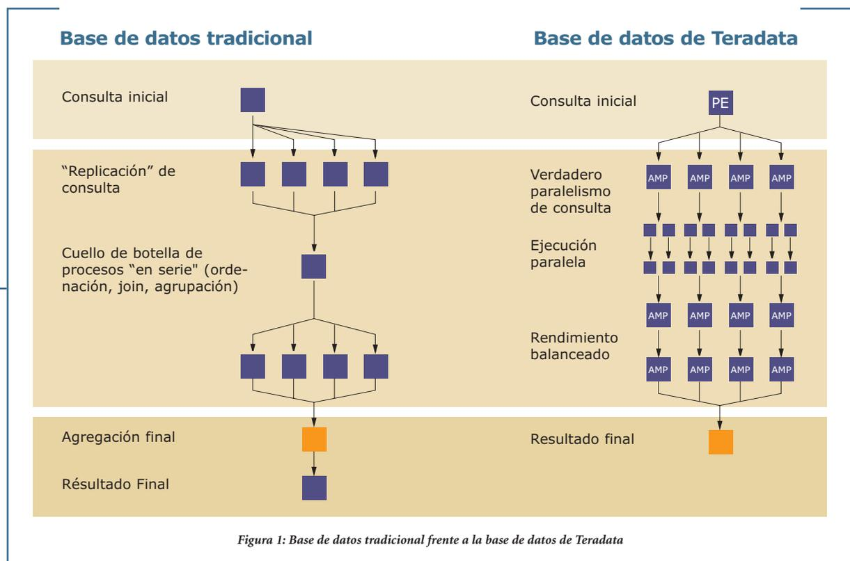
Figura 1: Base de datos tradicional frente a la base de datos de Teradata
