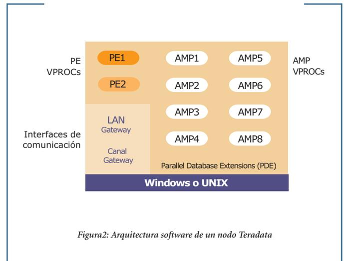
Figura2: Arquitectura software de un nodo Teradata
